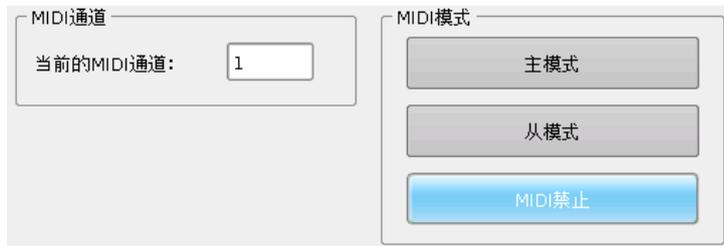
当设置为[主模式]时，控制台可以作为主设备去控制从设备触发；当设置为[从模式]时，控制台作为从设备，接受主设备的控制触发。
