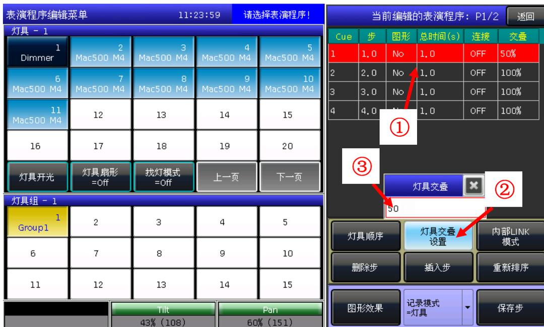
使用交叠功能时，程序步的运行时间将被平均分配到每个灯具中。例如，有 5 个灯使用 10 秒运行一步，当设置好交叠功能后，该步中的每个灯将使用 2 秒运行。
