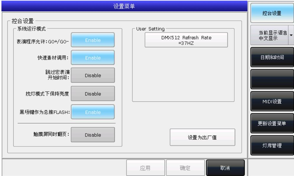
**表演程序允许 GO+/GO-** --- 该选项默认是[Enable]。当运行的多步程序连接模式为手动或 LINK 为 Off 时，重演推杆下面的按键作为触发 GO+/GO-的命令键使用。若选择[Disable]应用时，重演不为全电平输出时，按推杆下面的按键可使程序以最大电平输出。
