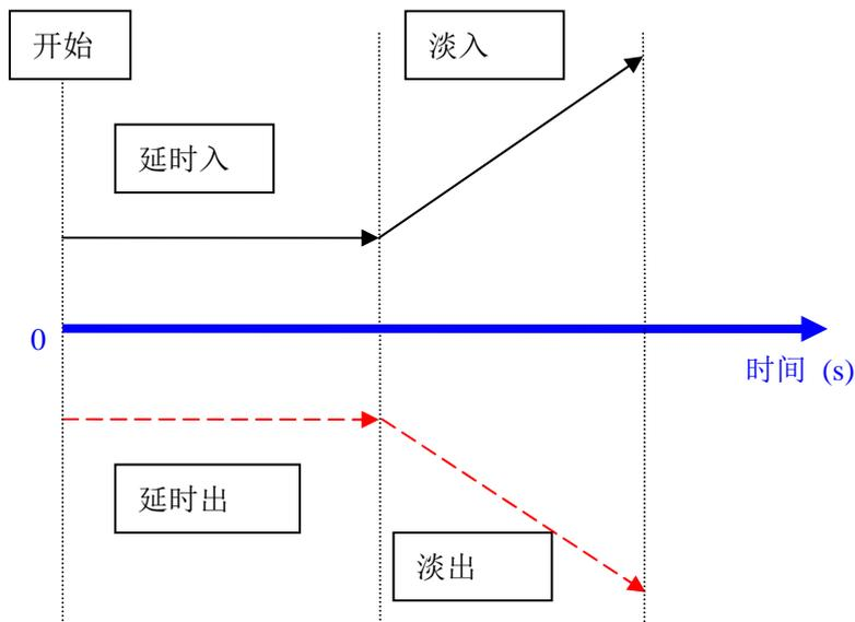
Cue-lists 程序的 4 个时间效果中，“延时入”和“延时出”时间首先同时开始运行。“淡入”时间将在“延时入”时间完成后开始运行；“淡出”时间将在“延时出”时间完成后开始运行。
