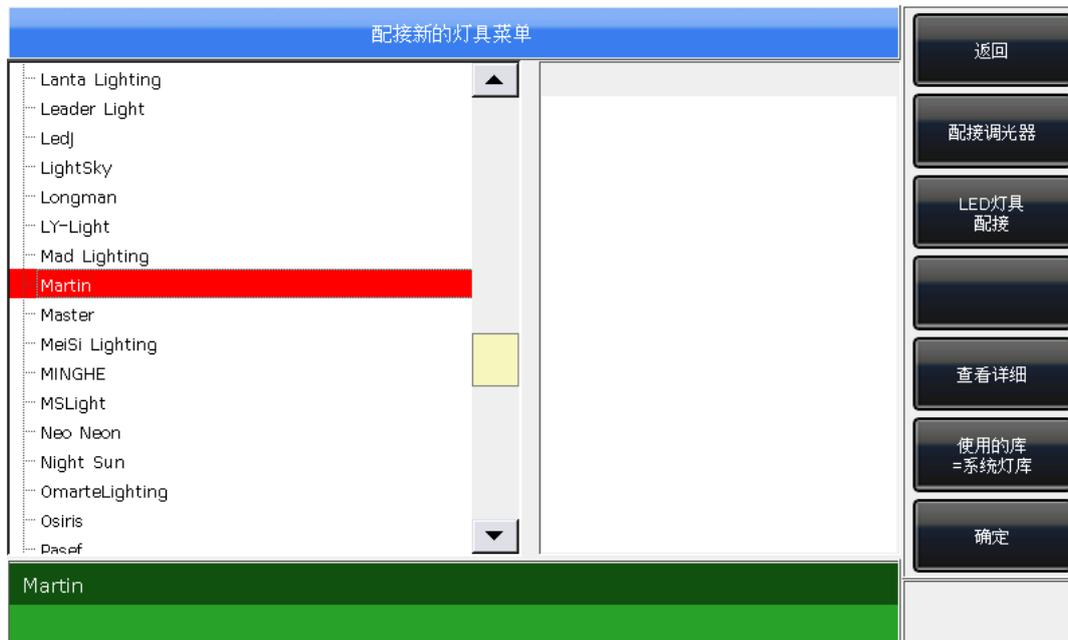
按[确定]进入制造商目录，可按上述方法寻找对应型号，触摸屏上点选对应型号后按[确定]。（点选型号后，将列出该型号的通道信息，如下图）
